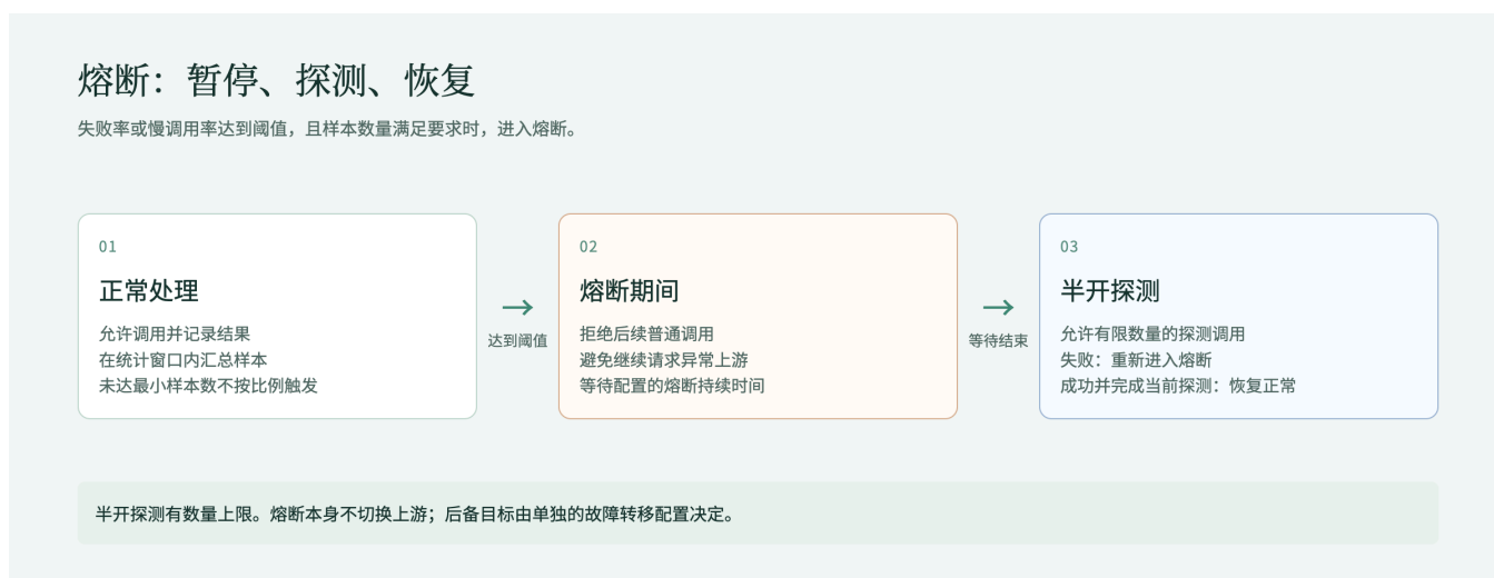
图 3：熔断状态示意。半开期间只允许有限数量的探测调用，仍可能拒绝其他请求。
