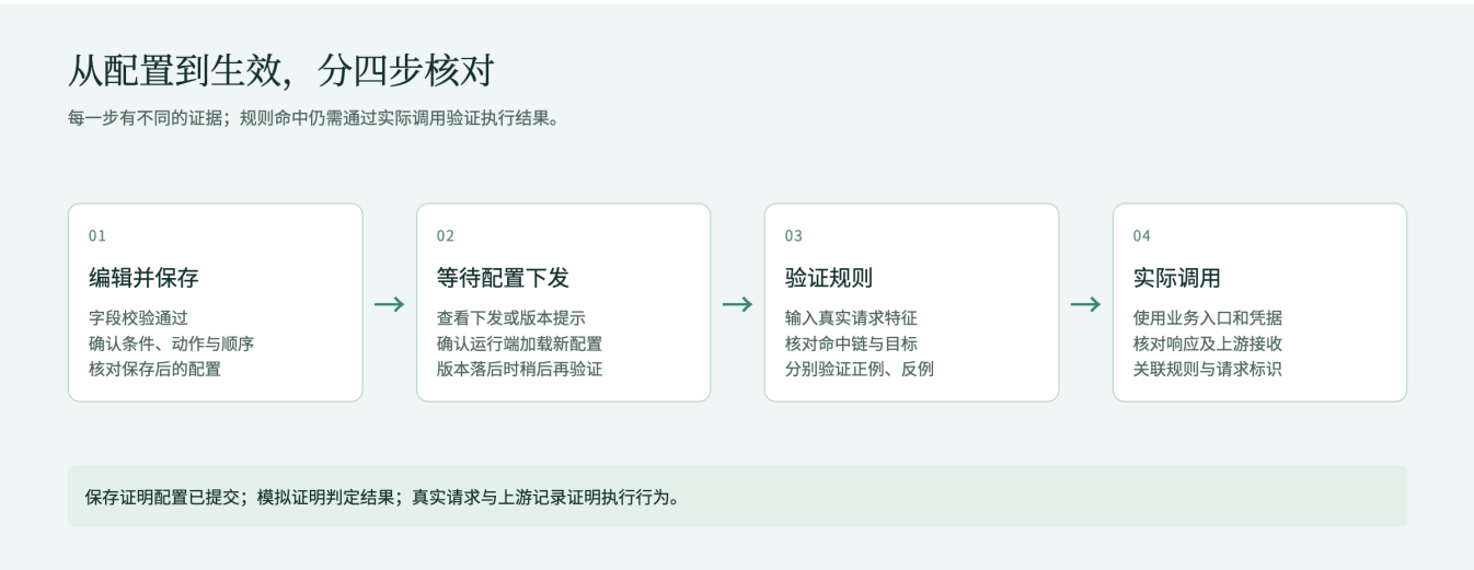
图 1：配置验证步骤示意。保存、下发、模拟和真实调用分别回答不同问题。
